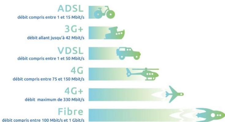
A partir de 2008, le déploiement de la  **fibre optique** , « très haut débit » débute en France. Une fibre optique est un fil dont l'âme, très fine et faite de verre ou de plastique. Elle a la propriété de conduire la lumière et sert pour l'éclairage ou la transmission de données numériques. Beaucoup plus performante (débit de connexion) que l'ADSL, cette technologie permet
